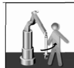
6.3.3 **Зона захвата или затягивания** - зона, создаваемая вращающимися деталями и узлами машин и механизмов, в которой человек или части его тела или одежды могут захватываться и затягиваться механизмами, в
